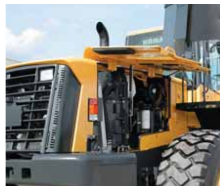
Hyvin esillä olevat huoltokohteet
