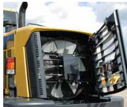
Automatická reverzace chodu ventilátoru
