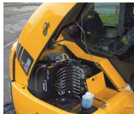
Höger lucka för enkel åtkomst till huvudventiler, bränsletank och verktygslåda.
