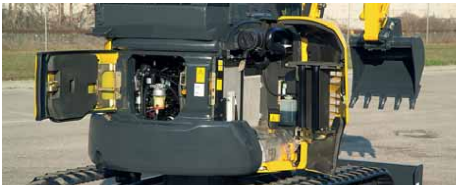
Capace de vizitare in partea din spate pentru verificari rapide ale motorului, inspectii si curatari ale radiatoarelor foarte simple si acces usor la baterie.
