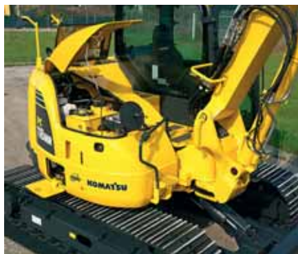
Alle viktige vedlikeholdspunkter kan enkelt rekkes fra bakkenivå
