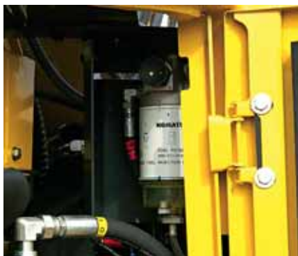
Drivstoff filter med vannutskiller
