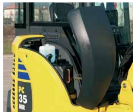
Voorste kap: snelle toegang tot de brandstoftank
