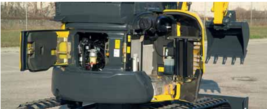
Avattavien luukkujen ansiosta moottorin tarkastus ja polttoaineen lisäys on nopeaa, jäähdytin on helppo tarkastaa ja puhdistaa, akut saa helposti esille
