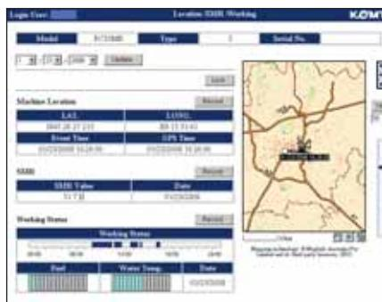
Produktivní čas stroje – S "Denním pracovním přehledem" ve formě grafu dostáváte přesné údaje o běhu motoru Vašeho stroje, jako např. kdy byl motor nastartován a zastaven, stejně jako o celkové době jeho běhu.
