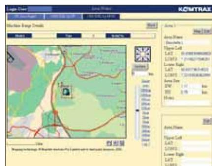
Další zabezpečení – Funkce "Uzámečení motoru" poskytuje možnost naprogramovat, kdy může být motor nastartován. S funkcí "Geo plotu" systém Komtrax zasílá upozornění o pohybu stroje v a mimo předem definovaný prostor.
