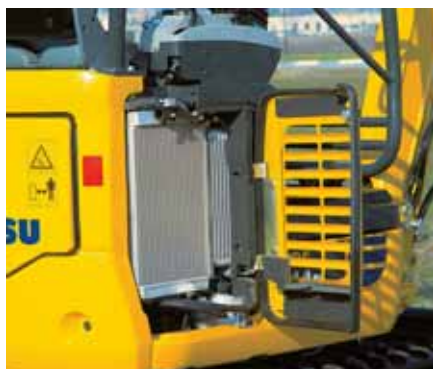
Capot direito: inspecção simples e limpeza dos radiadores
