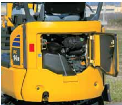
Capot traseiro: rápida verificação do motor e fácil acesso ao depósito de combustível
