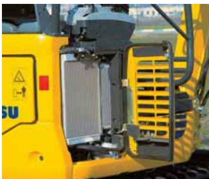
Десен капак: позволяващ лесен достъп за инспекция и почистване на радиаторите.
