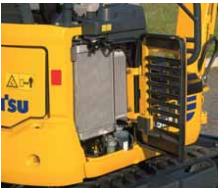
Jäähdytyn on helppo tarkastaa ja puhdistaa
