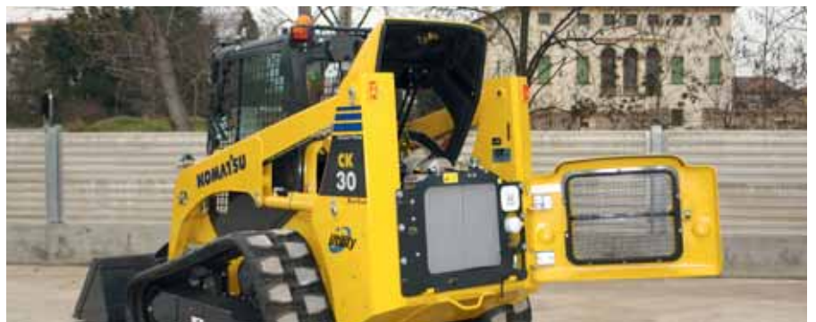
Capó trasero: inspección y limpieza simples de los radiadores
