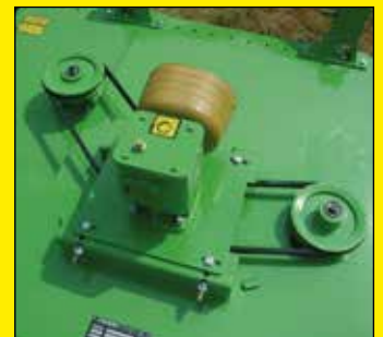
De verschillende rotors worden aangedreven door 2 V-riemen.
