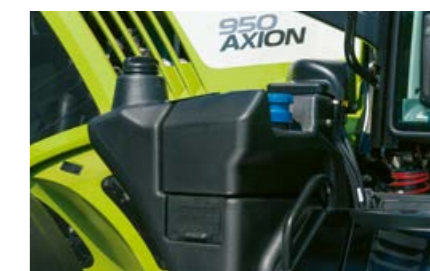
Zbiornik paliwa 640 l ze zintegrowanym zapasem 56 l mocznika
