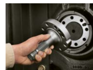
Facile sostituzione del codolo della presa di forza
