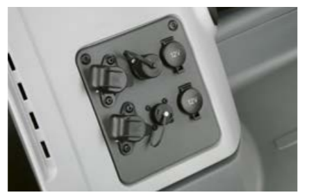
Le prese per l'alimentazione elettrica e ISOBUS per un terminale supplementare sono posizionate sotto la console destra
