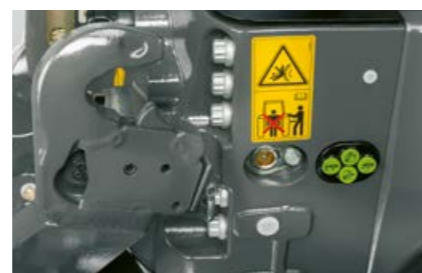
Comando esterno per sollevatore anteriore e un distributore
