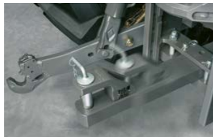
Le varianti di barra di traino mettono a disposizione diverse posizioni. Con la posizione estratta la manovrabilità è migliore.
