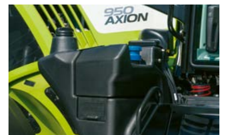
Serbatoio carburante da 640 l con serbatoio interno di 56 l per l'urea
