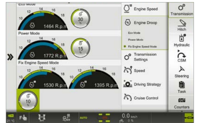
Impostazione del carico del motore per «Eco» e «Power» e memoria regime motore
