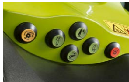
Comandi esterni per sollevatore posteriore, presa di forza e un distributore a scelta
