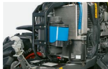
Il filtro dell'aria del motore posto davanti al radiatore può essere raggiunto facilmente dal suolo.
