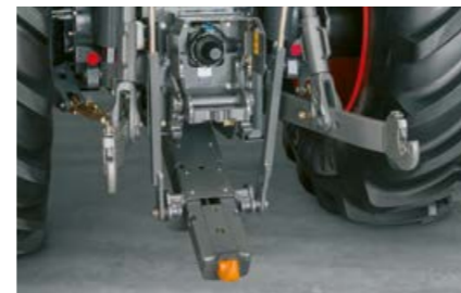
Un attacco con gancio hitch è un'alternativa al dispositivo d'aggancio conforme alla norma ISO 500.
