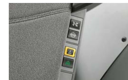
Attivazione della sospensione dell'assale anteriore
