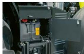
Accès optimal à la batterie à droite du marchepied d'accès à la cabine.
