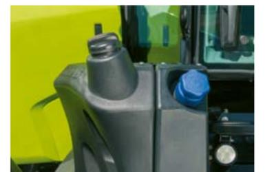
Réservoir de carburant de 455 l avec réservoir d'urée intégré de 42 l
