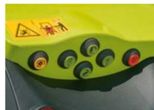
Commandes extérieures de la prise de force arrière déportées sur les deux ailes
