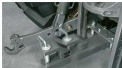
Les modèles de barre oscillante proposent plusieurs positions. La position déployée permet une maniabilité supérieure.
