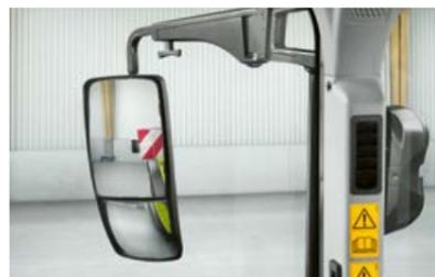
Un rétroviseur grand angle est proposé de série en plus du large rétroviseur pour une sécurité accrue sur la route.
