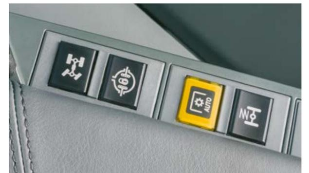
Activation de la suspension du pont avant
