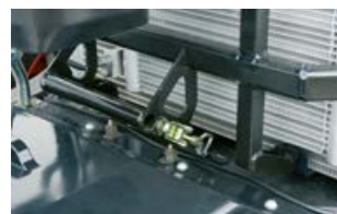
Puntos de engrase del eje delantero delante del paquete de radiadores para un acceso óptimo
