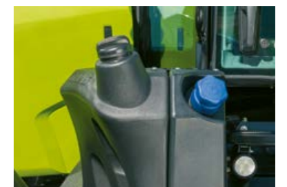
Depósito de combustible de 455 l con un depósito integrado de 42 l de urea
