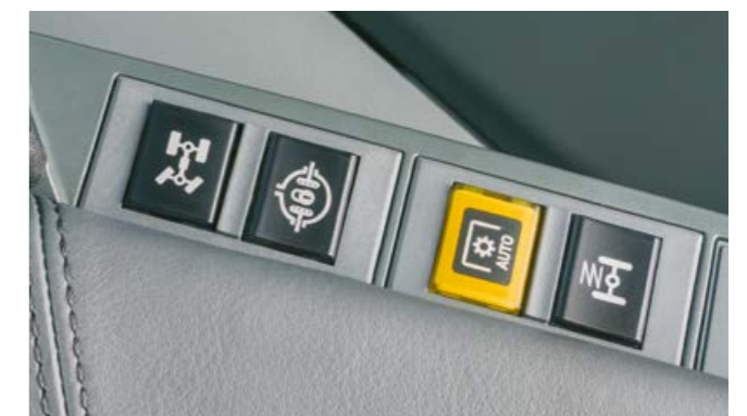
Activación de la suspensión del eje delantero
