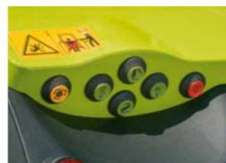
Mando externo para la toma de fuerza trasera en ambos guardabarros
