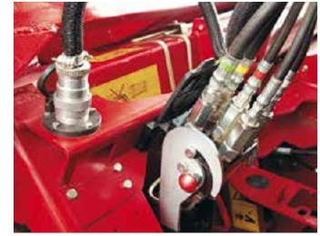
Montaż zespołu żniwnego w ciągu zaledwie kilku minut za pomocą jednego mechanizmu umożliwiającego podłączenie wszystkich złączy hydraulicznych
