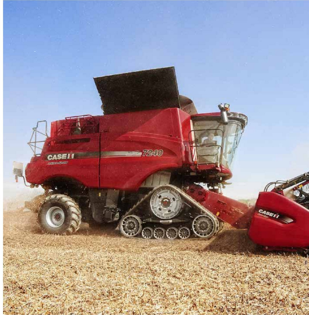
Case IH Raupenlaufwerke bewähren sich seit Jahren auf Quadtrac Schleppern.
