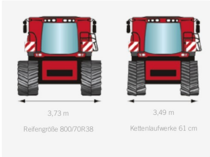
Unter 3,50 m Transportbreite mit Kettenlaufwerken
