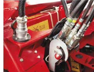
Dank Multikuppler für die Hydraulik ist das Ankopplern des Vorsatzes in wenigen Minuten erledigt
