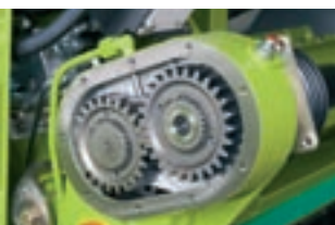
Sostituzione dei pignoni dentati per l'adeguamento giri
