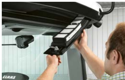
Filtr powietrza kabiny umieszczono na zewnątrz kabiny i można go łatwo wyjmować.
