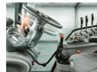
Kierownica jest przestawiana w dwóch płaszczyznach, co pozwala perfekcyjnie dopasować ją do każdego operatora.
