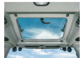
Dzięki szklanemu lukowi w dachu operator zawsze widzi ładowacz czołowy i może przez cały czas pracować bezpiecznie i precyzyjnie.
