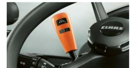
Les gammes et les rapports se commandent par le biais de deux leviers de commande. Un bouton d'embrayage sur le levier de passage des rapports remplace la pédale d'embrayage.
