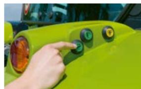
Les commandes déportées sur les deux ailes permettent de relever et d'abaisser le relevage arrière.
