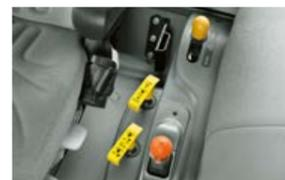
Tous les régimes de prise de force peuvent être facilement présélectionnés à gauche du siège conducteur.
