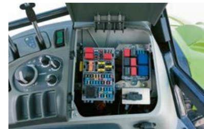
Les fusibles du circuit électrique sont installés de façon centrale dans la cabine.
