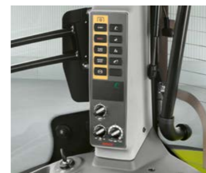
Prędkości WOM oraz elektroniczna regulacja tylnego podnośnika w słupku B
