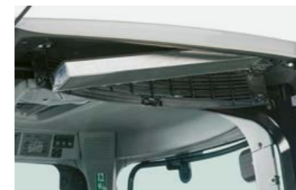
Łatwy dostęp do filtra powietrza w dachu kabiny
