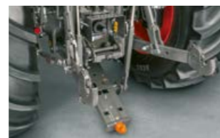
Alternatywnie do koźła zaczepu dostępne jest sprzęgło z hakiem Hitch.
