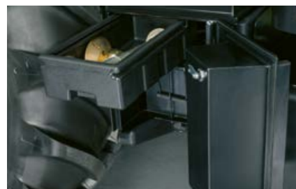
Akumulator i skrzynka na narzędzia są dobrze dostępne po prawej stronie wejścia.
