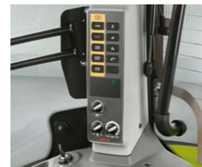
Prędkości WOM oraz elektroniczna regulacja tylnego podnośnika w słupku B
