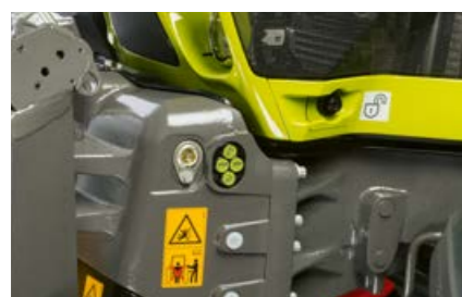
Obsługa przedniego podnośnika i zaworów hydraulicznych z zewnątrz (zależnie od wyposażenia)
