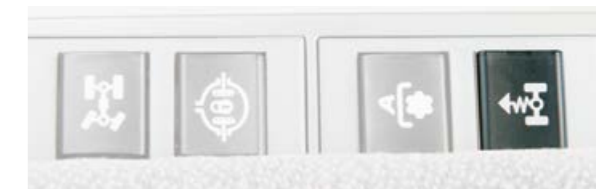
Aktywacja amortyzacji przedniej osi
