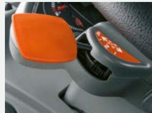
NOWOŚĆ: dostępna dźwignia zmiany biegów REVERSHIFT z elektronicznym hamulcem postojowym
