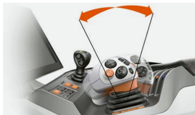
Obsługa progresywna dzięki technologii bezstopniowej przekładni CMATIC
