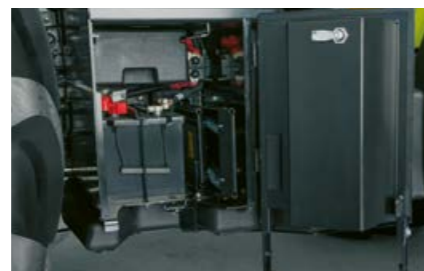
Akumulator i skrzynka na narzędzia są dobrze dostępne po prawej stronie wejścia.
