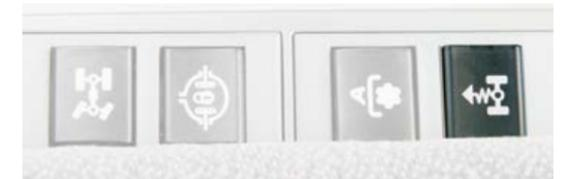
Activation de la suspension du pont avant
