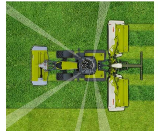
Grâce à la disposition particulière des montants arrière de cabine et à la vitre arrière galbée, le conducteur bénéficie d'une vue dégagée sur l'outil et la zone d'attelage.
