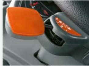
NOUVEAU : inverseur sous charge REVERSHIFT avec frein à main électro-hydraulique Parklock
