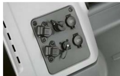
Les connexions pour l'alimentation des circuits électriques et les liaisons ISOBUS pour les terminaux additionnels sont regroupées sous la console de droite.
