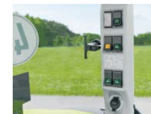
Obsługa świateł roboczych jest logicznie zestawiona w słupku B.
