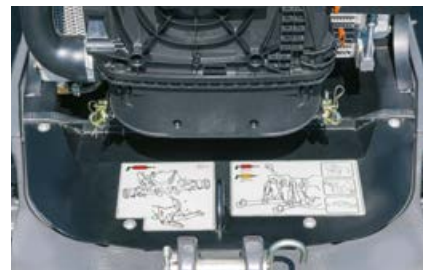
Pod maską silnika znajduje się harmonogram smarowania, który ułatwia proces konserwacji.
