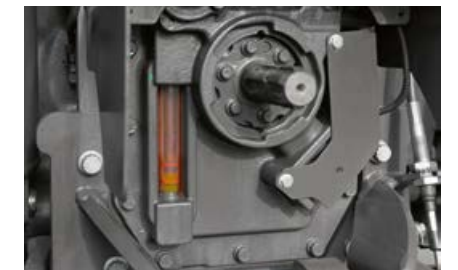
Łatwa kontrola stanu oleju przekładni i hydrauliki przez wzmianki WOM.
