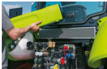
Łatwo dostępny filtr powietrza z tyłu kabiny.
