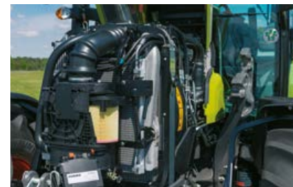
Łatwe wyjmowanie filtra powietrza silnika przed chłodnicami.
