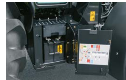
Akumulator i skrzynka na narzędzia są łatwo dostępne po prawej stronie wejścia.
