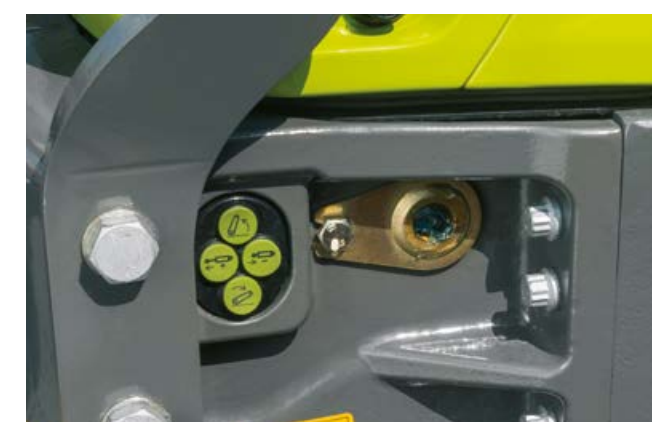
Elektroniczne zawory umożliwiają również zewnętrzną obsługę przedniego podnośnika i dodatkowego zaworu sterującego.
