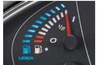
Wskaźniki stanu napelnienia mocznikiem i paliwem umieszczone w tablicy przyrządów.
