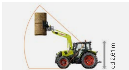
Kabina PANORAMIC z panoramiczną szybą przednią i przeszklonym dachem: wysokość do przejazdów powyżej 2,61 m.
