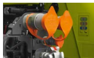
Maszyny wymagające dużych wydatków hydrauliki zaopatrywane są w olej przez układ Load Sensing z przyłączami Power-Beyond.
