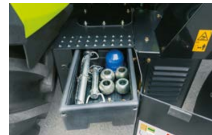
Akumulator i skrzynka na narzędzia są łatwo dostępne po prawej stronie wejścia.
