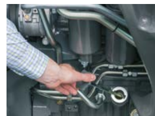
Bagnet pomiaru stanu oleju jest łatwo dostępny także przy dołączonym ładowaczu czołowym.
