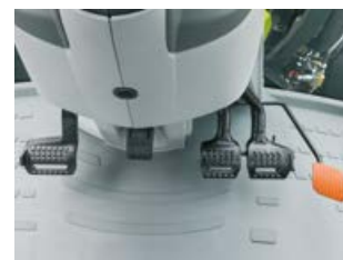
Zwykły nacisk na pedał automatycznie unosi kolumnę kierownicy do góry, umożliwiając wygodne wysiadanie.
