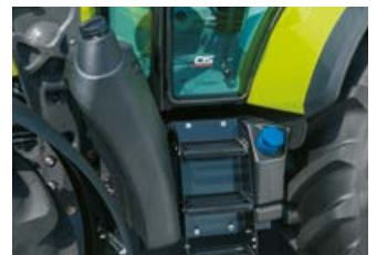
Króćce wlewu dla 17 lub 22 l roztworu mocznika i 140 lub 190 l paliwa umieszczone z lewej strony przy wejściu.
