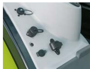
W kabinie są przyłącza prądu i dla terminala zdolnego do współpracy z ISOBUS.
