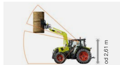
Kabina z dachem wysokim ze szklanym szyberdachem: wysokość do przejazdów powyżej 2,61 m.
