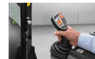
Obsługa elektronicznych zaworów odbywa się przełącznikami kołkowymi proporcjonalnymi w bocznej konsoli i przez ELECTROPILOT w uchwycie wielofunkcyjnym.
