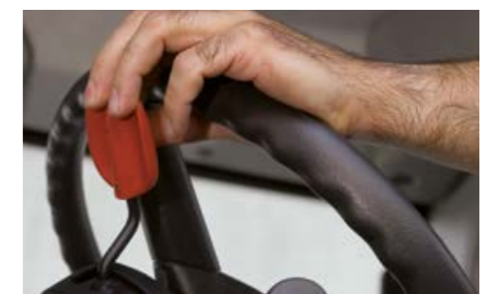
Дополнительно к классической функции переключения поворотов REVERSHIFT предлагает функцию расцепления.
