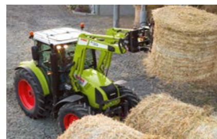
Производительность гидросистемы до 98 л/мин гарантирует быстрое управление фронтальным погрузчиком.
