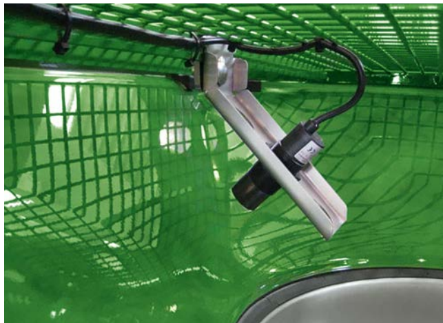
✓ Üresjelzés-érzékelő a ZA-TS műtrágyaszóróban
