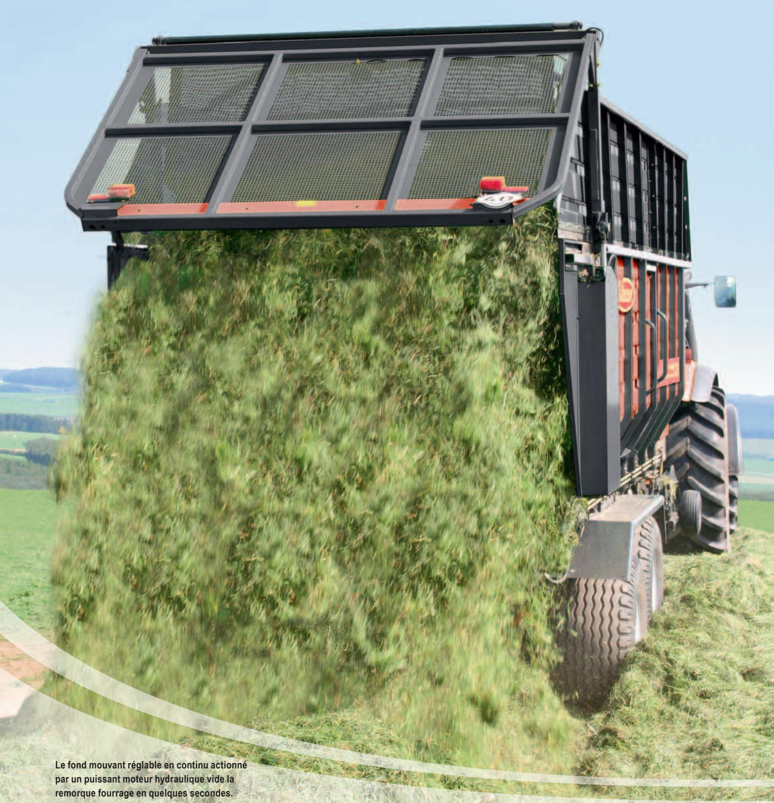
Le fond mouvant réglable en continu actionné par un puissant moteur hydraulique vide la remorque fourrage en quelques secondes.
