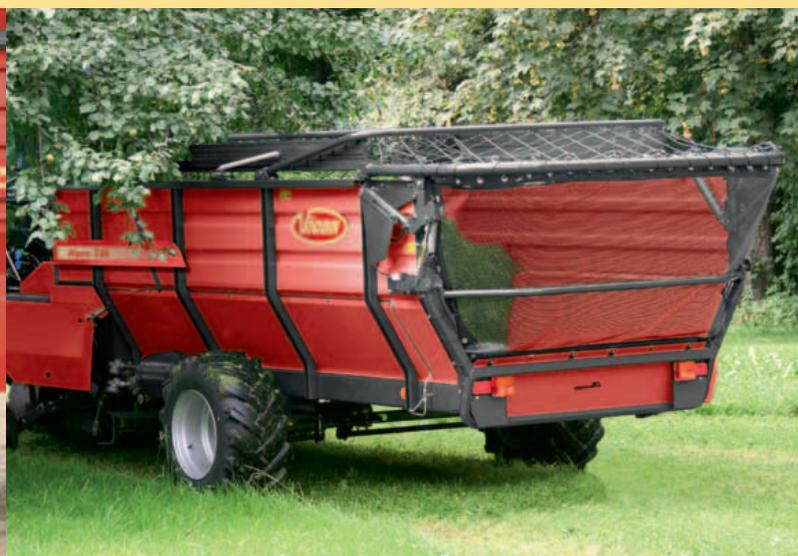
Structure pour fourrage sec hydr. pour les modèles Alpex - Feedex 300 et 360 S/T. Adaptation simple de la hauteur de chargement depuis la cabine du tracteur.
