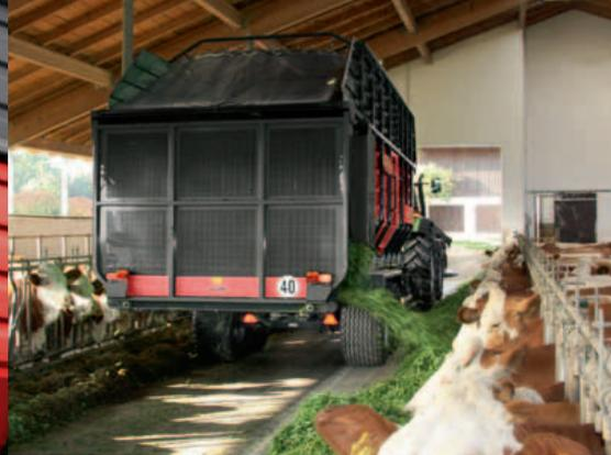
Le transporteur transversal bidirectionnel permet une décharge sur la gauche ou la droite.
