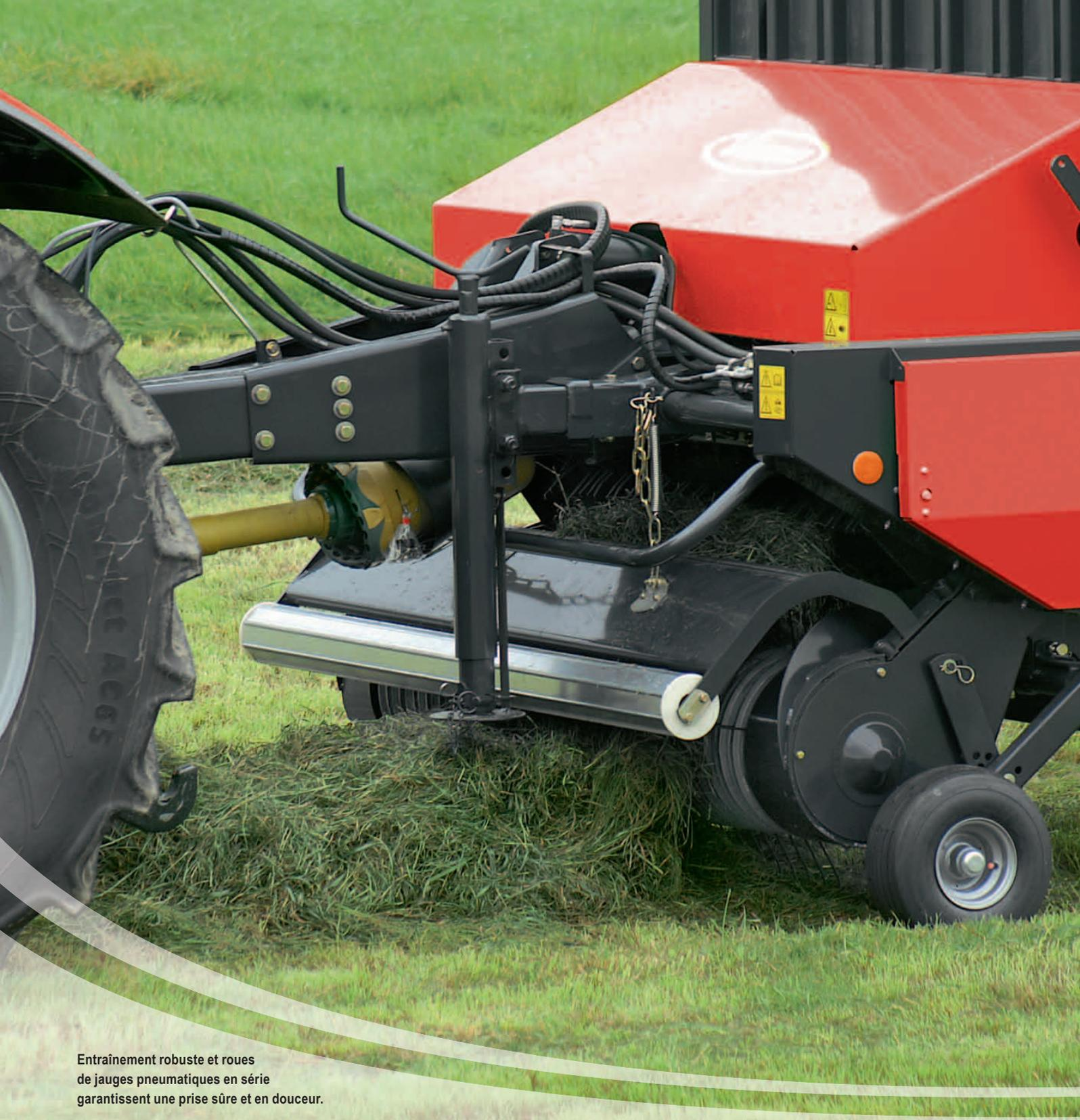
Entraînement robuste et roues de jauges pneumatiques en série garantissent une prise sûre et en douceur.
