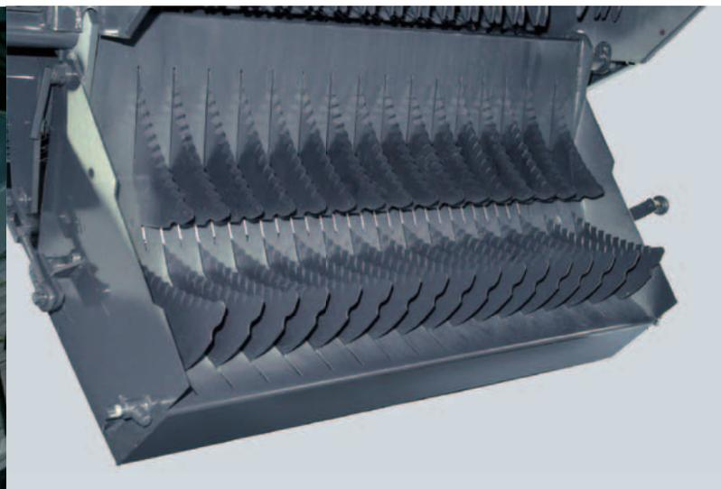
Système de coupe 33 couteaux (16 + 17) en option sur Feedex 300 - 360 et 390. 16 couteaux maxi sur Alpex, standard sur Feedex 422 et 440.
