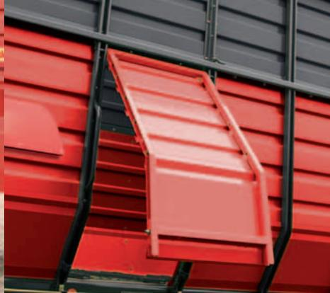
Une trappe de maintenance est standard sur la Feedex 422.
