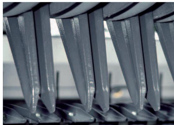
Les dents des peignes convoyeurs assurent une capacité de chargement optimale quel que soit le type de fourrage.
