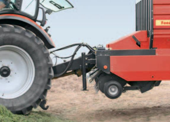
Le timon hydraulique donne une garde au sol de 600 mm et permet ainsi une entrée sûre dans n'importe quel silo.
