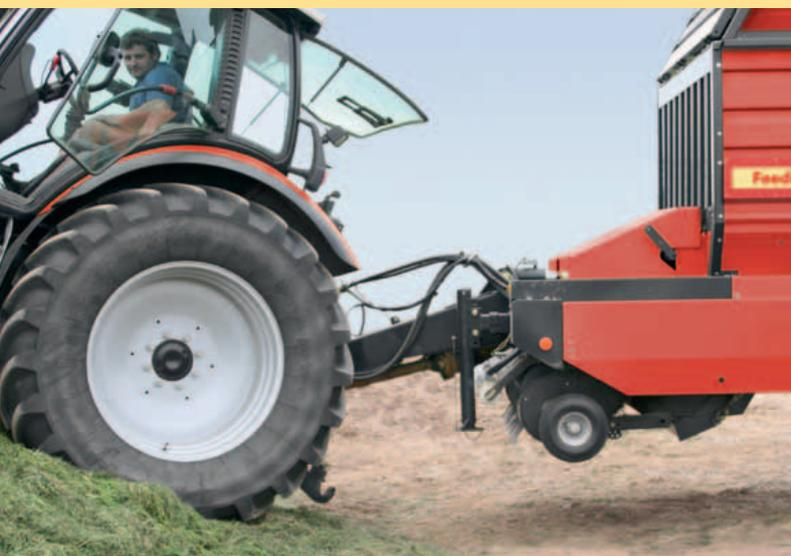
Timon hydraulique en option pour les modèles Alpex - Feedex 300 - 360. La garde au sol élevée garantit un passage sûr de rampes, talus et d'entrée dans les silos.
