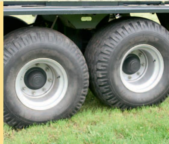
Châssis confortables avec larges pneumatiques taille basse pour ménager la couverture végétale.
