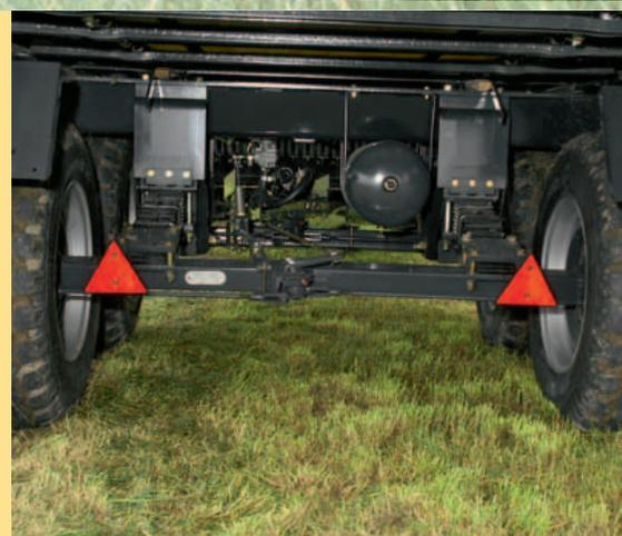
Les essieux tandem sont à suspension pneumatique en série et possèdent de larges pneumatiques.
