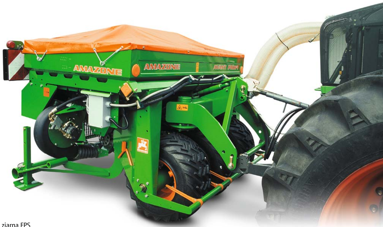
Czołowy zbiornik ziarna FPS ze skrętnym czołowym oponowym wałem ugniatającym
