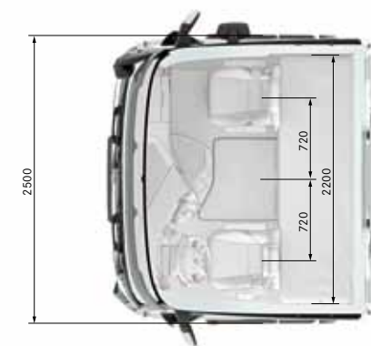
L-cab exterior width 2500 mm
