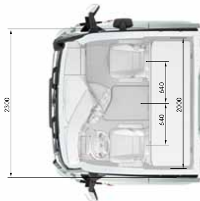
L-cab Exterior width 2300 mm
