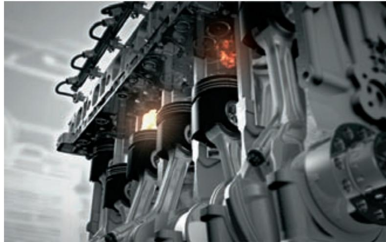
Die Common-Rail-Hochdruckeinspritzung sorgt in praktisch jeder Fahrsituation für eine besonders effiziente, schadstoffarme Verbrennung des Kraftstoffs. Das trägt zu einem niedrigen Verbrauch, reduzierten CO<sub>2</sub>-Emissionen und damit zu niedrigen Kosten bei.
