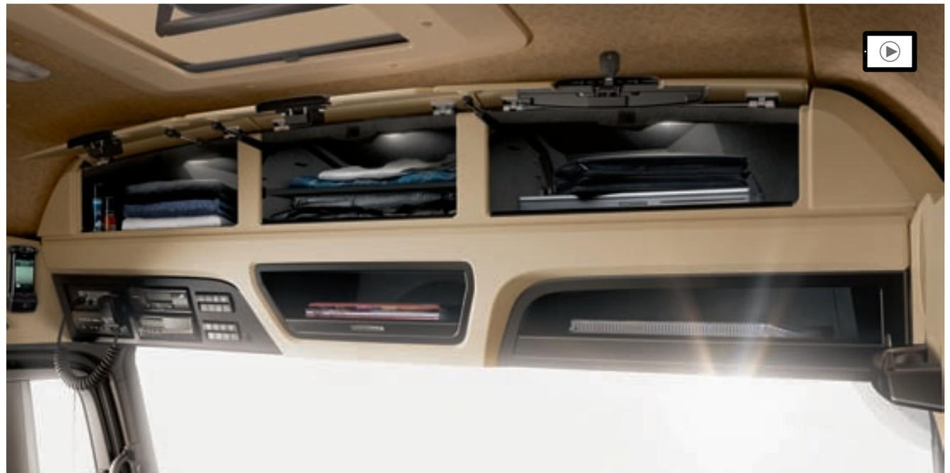
Hervorragendes Verhältnis zwischen Aerodynamik und Stauraumvolumen – im 2300 mm breiten StreamSpace-Fahrerhaus mit ebenem Boden bieten drei innen verkleidete Staufächer über der Windschutzscheibe mit insgesamt 137 l Stauvolumen jede Menge Platz. Optional ist das große Staufach auf der Beifahrerseite mit 26 l Volumen auch mit einem abschließbaren Klappdeckel erhältlich. Für noch mehr Sicherheit findet hier auf Wunsch auch ein einbruchhemmendes Wertfach seinen Platz.
