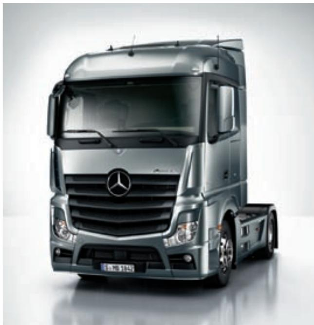
Das StreamSpace-Fahrerhaus mit 2500 mm Breite verbindet die besonders kraftstoff sparende Aerodynamik mit einem herausragenden Raum- und Stauraumangebot – konzipiert für Einsätze im internationalen Fernverkehr.
