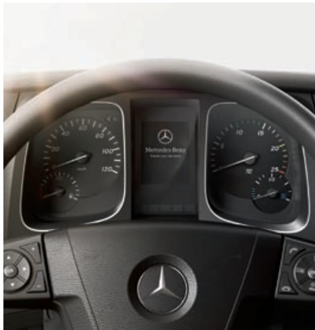
Das neue Kombiinstrument mit grafikfähigem 10,4 cm-TFT-Farbdisplay trägt spürbar zu mehr Bedienkomfort bei. Auf Wunsch ist eine Variante mit 12,7 cm-TFT-Farbdisplay erhältlich.
