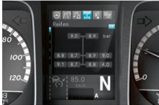
Die optional erhältliche Reifendruckkontrolle trägt beispielsweise zu einer längeren Lebensdauer der Reifen, zu einem verringerten Pannrisiko und zu einem niedrigen Verbrauch bei. Wenn Ihr Auflieger mit einer entsprechenden Sensorik ausgestattet ist, können Sie den Reifendruck des gesamten Zuges überwachen.
