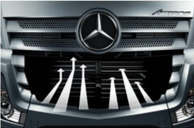
Die neue, serienmäßige Kühlerjalousie verbessert im geschlossenen Zustand die Aerodynamik und spart dadurch Diesel. Sie wird je nach Kühlungsbedarf des Motors entsprechend geöffnet oder geschlossen.
