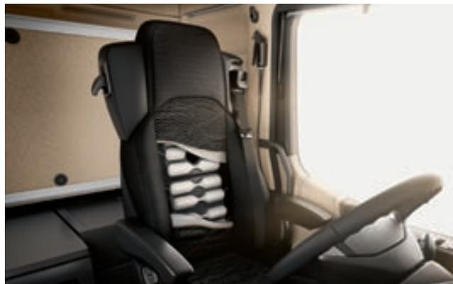
Zur Vorbeugung gegen Verspannungen sind der Komfort- und der Klima-Schwingsitz mit einer Massagefunktion erhältlich: Dabei werden sieben Luftpolster nacheinander auf- und wieder abgeblasen. Dadurch wird eine nach oben laufende Welle erzeugt, die den Rücken des Fahrers massiert.
