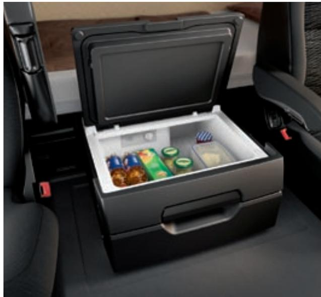
Bei Fahrerhäusern mit Motortunnel ist im Mittelteil unter dem Bett eine praktische Schublade mit einem Volumen von 51 l untergebracht. Optional ist auch ein Kühlschrank mit 26 l Volumen lieferbar.
