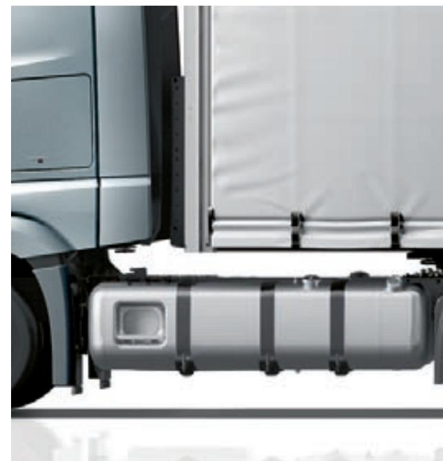
Großes Volumen auch bei Euro VI – mit einem Tankvolumen von bis zu 990 l bei Sattelzugmaschinen und bis zu 1000 l bei Niedrigrahmen-Pritschenfahrzeugen bietet der Actros Volumer eine besonders große Reichweite für Volumentransporte.
