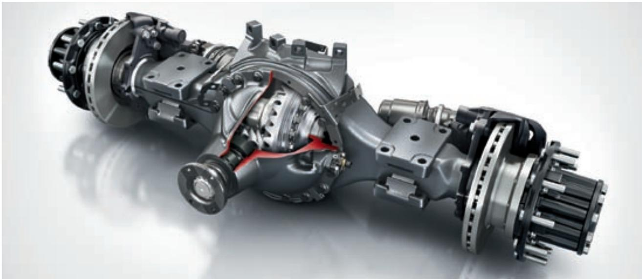
Leicht, sparsam und jetzt mit einem lückenlosen Übersetzungsprogramm: Die weiterentwickelte, einstufig übersetzte Hypoid-Hinterachse trägt im neuen Actros serienmäßig durch weniger Reibung zu einem niedrigen Verbrauch im Vergleich zum Vorgängermodell bei.
