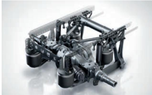
Die weit außen angebrachten Luftfederbälge der neuen, serienmäßigen 4-Balg-Luftfederung sorgen in Verbindung mit der innovativen Hinterachsführung<sup>1)</sup> für ein wesentlich verbessertes Wankverhalten bei Fahrbahnunebenheiten und für eine spürbar geringere Seitenneigung in Kurven.
