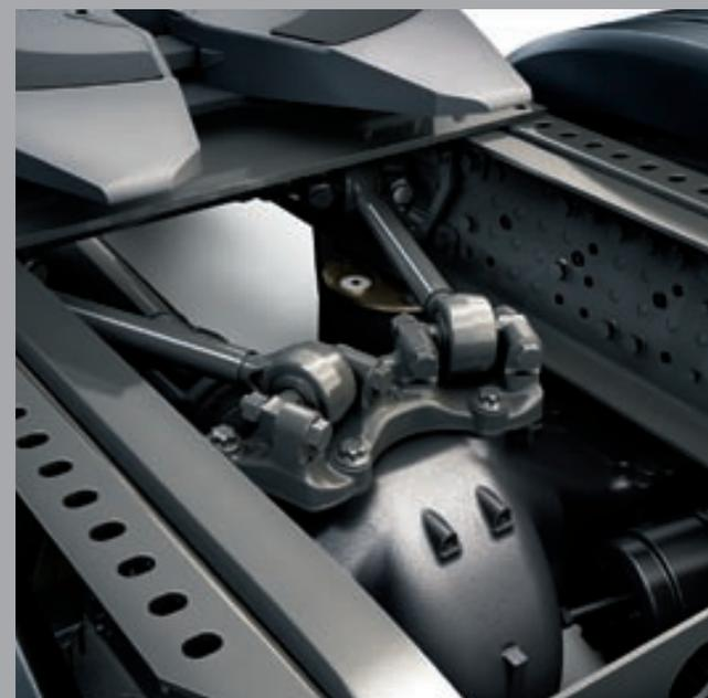
Innovative Hinterachsführung<sup>1)</sup>: Anstelle eines herkömmlichen Dreieckslenkers kommen beim neuen Actros zwei Längslenker mit Wirklinienschnittpunkt hinter der Antriebsachse zum Einsatz. Das sorgt für eine bessere Zielgenauigkeit, ein spürbar besseres Eigenlenkverhalten und mehr Querstabilität. Mehr dazu auf den Seiten 38/39.
