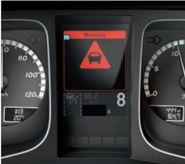
Der neue Active Brake Assist 3 kann eine drohende Kollision mit einem stehenden Hindernis jetzt auch mittels einer Vollbremsung verhindern beziehungsweise die Aufprallgeschwindigkeit erheblich reduzieren. So können Unfälle vermieden oder die Unfallschwere deutlich reduziert werden.
