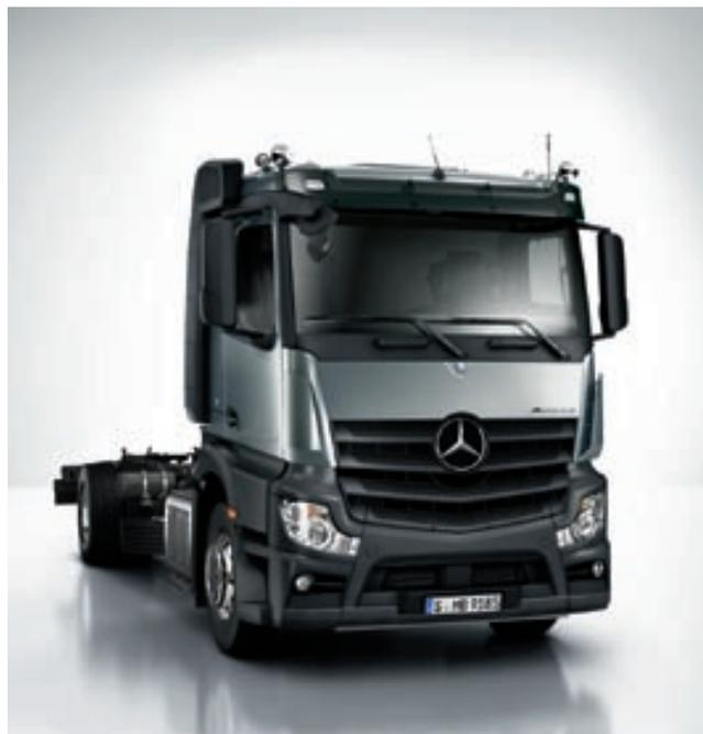
Das ClassicSpace-Fahrerhaus mit 2300 mm Breite und 170 mm oder 320 mm hohem Motortunnel zeichnet sich durch eine gute Einsatzorientierung im regionalen Fernverkehr aus.
