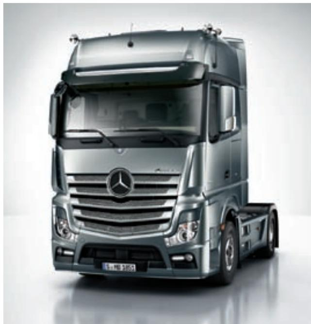
Das GigaSpace-Fahrerhaus: Mit 2500 mm Breite, durchgehend ebenem Boden und einer Stehhöhe<sup>1)</sup> von 2,13 m ist es das größte und komfortabelste Fahrerhaus des neuen Actros und wird selbst hohen Anforderungen im internationalen Fernverkehr gerecht.
