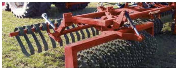
Ausgestattet mit einem Clod board ist die Actiroll HDC ein universelles Gerät zur Saatbettbereitung. Da jede Sektion mittig aufgehängt ist, folgt die Walze allen Bodenkonturen und gewährleistet somit eine gleichmäßige Einebnung und Rückverfestigung.
