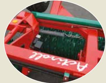
Mit zwei starken Federn wird die gleichmäßige Gewichtsverteilung auf die einzelnen Walzensegmente gewährleistet (für Actiroll/Actiroll Classic von 6,30 m bis 8,30 m). Bei der Actiroll 9,30 m sowie bei der Actiroll HD/HDC (9,50 m bis 18,30 m) wird die Last durch zwei Hydraulikzylinder transferiert.
