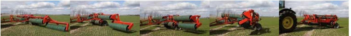
Dank ihres kompakten Designs liegt die Transportbreite der Actiroll HD und HDC unabhängig vom Ringdurchmesser unter drei Meter. Die Seitenflügel werden mechanisch verriegelt. Zusätzlich sind die Klappzylinder mit Sperrblöcken für besonders hohe Sicherheit ausgestattet. Aufgrund ihres niedrigen Schwerpunktes bietet die Actiroll HD und HDC ein besonders gutes und ruhiges Fahrverhalten auf der Straße.
