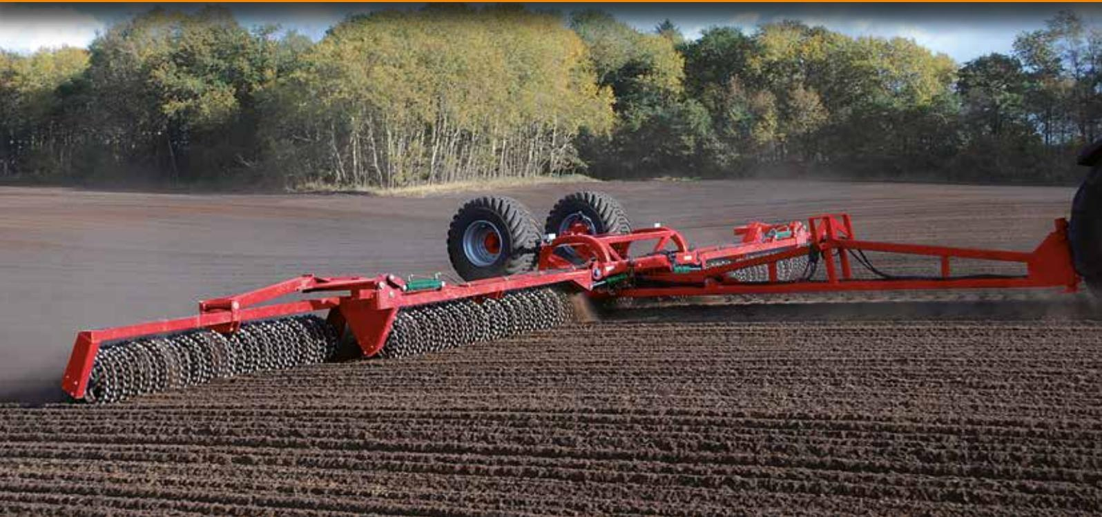
Die Actiroll HD und HDC in Arbeitsbreiten von 10,30 bis zu 24,30 m sind mit dem hydraulischen Gewichtsenausgleich Contoura ausgestattet: das Gewicht vom Rahmen wird gleichmäßig über zwei Hydraulikzylinder auf die Seitenflügel
