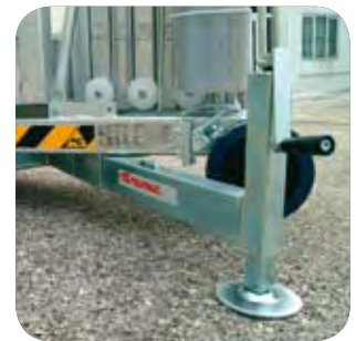
N. 4 stabilizzatori che permettono di utilizzare la piattaforma in punti non pianeggianti. No. 4 stabilizers if needed for unlevelled grounds.
