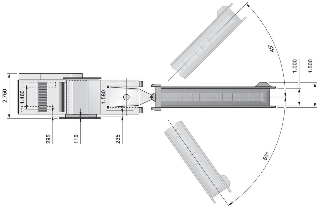
\* = Dimensioni per caricamento su autocarro a pianale ribassato
