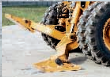
ABSTÜTZUNGEN UND PLANIERSCHILD SIND UNABHÄNGIG ANSTEUERBAR.
