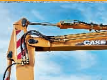
PATENTIERTE SICHERHEITSVENTILE AN AUSLEGER UND LÖFFELSTIEL
