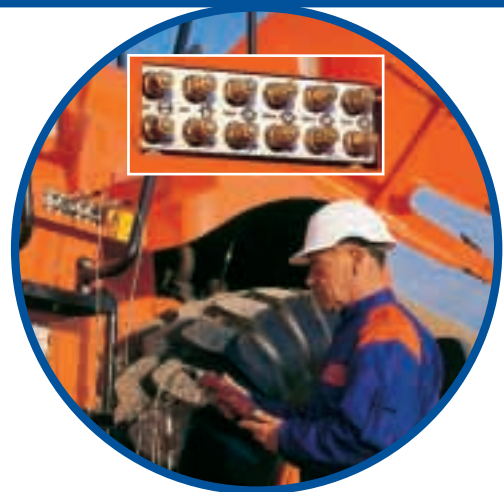
12 zentral angeordnete Druckmeß-Anschlüsse
