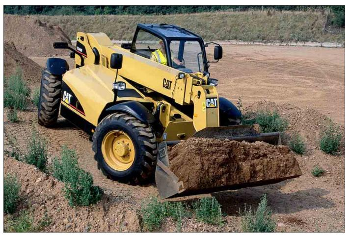
**Dieselmotor.** Der elektronisch gesteuerte Cat Dieselmotor 3054E arbeitet besonders schadstoffarm und unterschreitet daher alle derzeit gültigen Abgasemissionsgrenzwerte. Darüber hinaus bietet die moderne Elektronik zusätzliche gravierende Vorteile:
