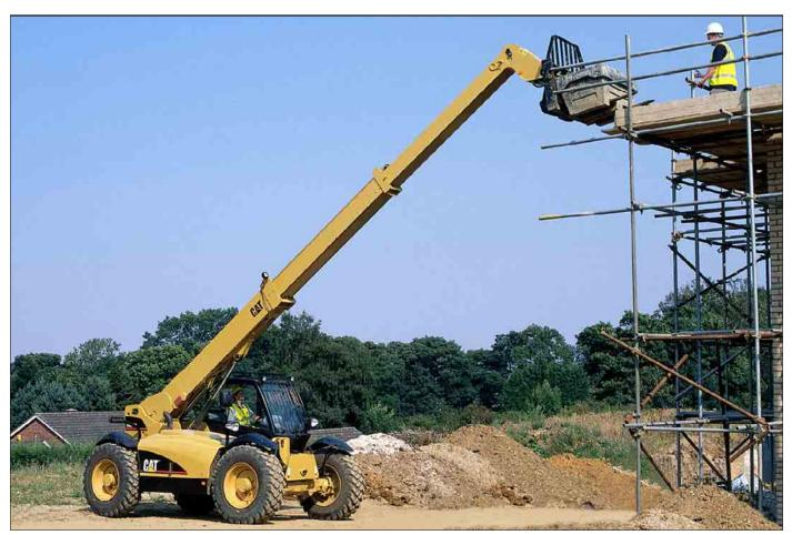
**Hubhöhe.** Mit dem Teleskopausleger des TH340B lassen sich zum Beispiel Mauerziegel, Dacheindeckungen und Fachwerkträger in Sekundenschnelle auf bis zu 9500 mm Höhe anheben und präzise positionieren.
