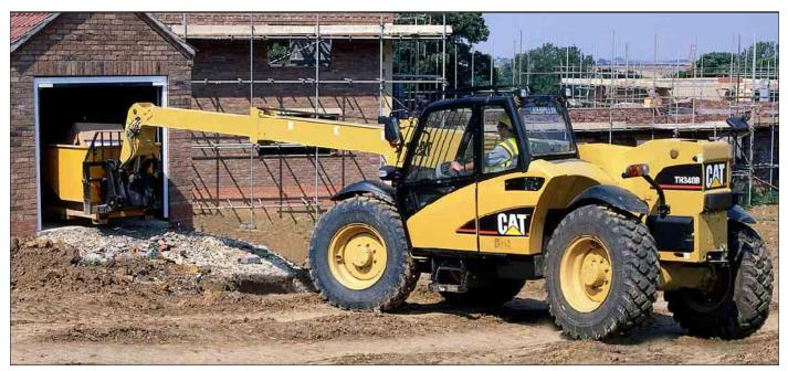
Zusatzhydraulik. Soll der TH340B in Verbindung mit hydraulischen Anbaugeräten eingesetzt werden, kann man die serienmäßige Zusatz-Hydraulik zum Ansteuern verwenden. Darüber hinaus ist ein Konstantstrom-Hydraulikkreis lieferbar wie er beispielsweise für Kehrbesen benötigt wird.
