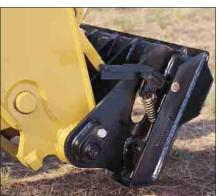
Schnellwechsler. Der serienmäßige, manuelle Schnellwechsler erlaubt den raschen Austausch verschiedener Arbeitsgeräte. Beim TH215 wird der gleiche Schnellwechsler verwendet wie bei den Caterpillar Kompaktladern.
