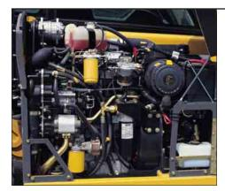
**Zugänglichkeit.** Weil sich der Dieselmotor des TH215 seitlich an der Maschine befindet, sind die Wartungsstellen mühelos vom Boden aus erreichbar. Deshalb lassen sich die im beigefügten Betriebs- und Wartungshandbuch vorgeschriebenen Arbeiten einfach und schnell durchführen.
