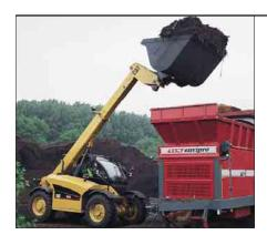
**Kompaktbauweise.** Kleine Abmessungen und beeindruckende Wendigkeit prädestinieren den Telehandler TH215 für Einsätze in beengten Platzverhältnissen und/oder bei geringen Durchfahrhöhen.
