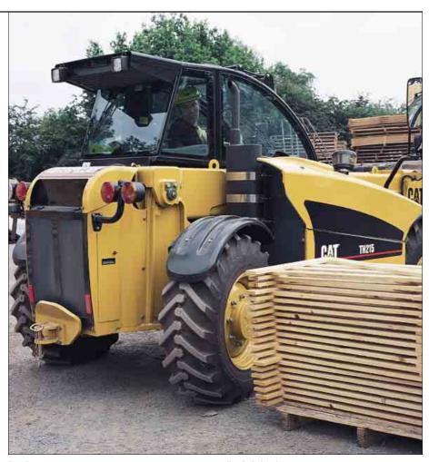
Lenkung. Der Fahrer kann entsprechend der Betriebssituation zwischen Vorderradlenkung, analoger Allradlenkung und paralleler Allradlenkung (Hundegang) wählen. Die Umschaltung der Lenkungsarten erfolgt über einen Schalter in der Kabine. Eine Kontrollleuchte zeigt die korrekte Ausrichtung der Räder an.
