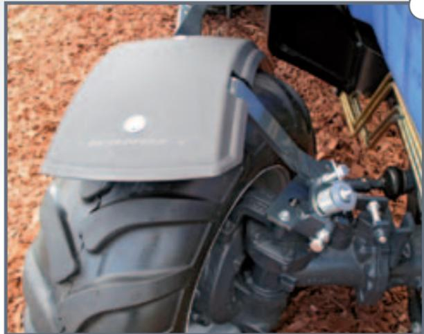
Flexibel wie der Fahrer: Schwenkbare Kotflügel (optionale Ausstattung) zum Schutz der Maschine bzw. Leitungen.
