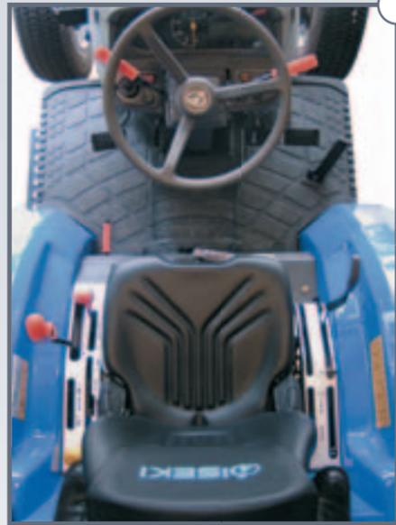
Die Fahrerplattform ist großräumig gestaltet und alle Bedienelemente sind übersichtlich angeordnet.
