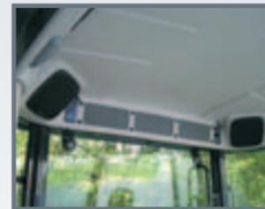
Seitliche Anordnung der Lautsprecher-Vorbereitung, große Luftauslass-Düsen mit Microfilter sorgen für angenehmes Kabinen-Klima.
