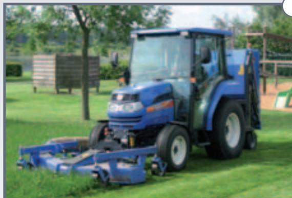
ISEKI-Grasaufnahmen bieten bis zu 1600 Liter Behältervolumen. Über eine hydraulische Hochentleerung kann direkt und bequem bis zu 210 cm Höhe in einen Absetzcontainer oder Anhänger entleert werden. Die Absaugurbine ist aus massivem Stahl gefertigt und kann somit auch bei widrigen Einsätzen verwendet werden.
