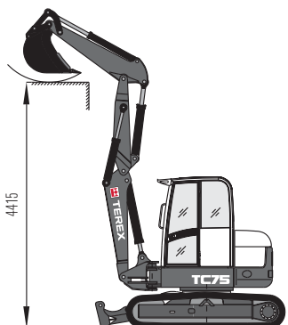
Fig. 2: Braccio ad orbita circolare - altezza di carico
