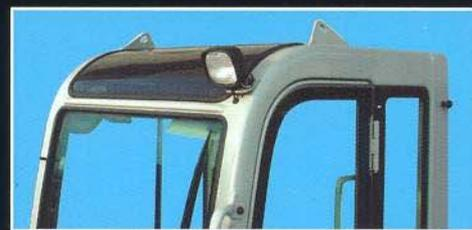
**D**achhösen für unkompliziertes Anhängen der Maschine
