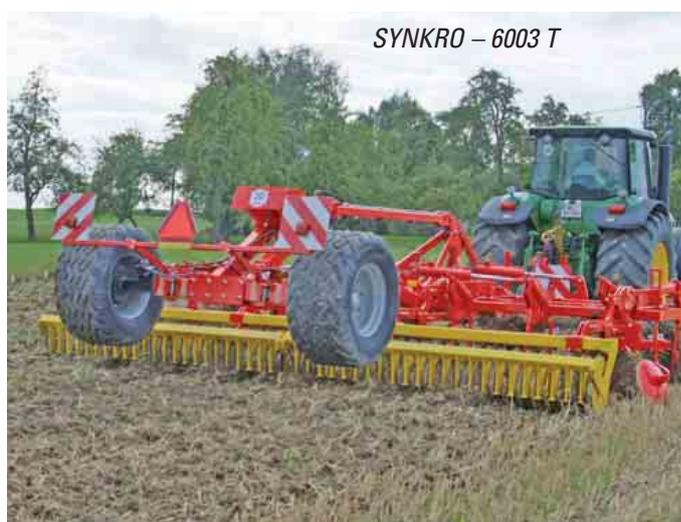
El mecanismo de traslación de transporte se encarga de que no se produzcan sobrecargas en el mecanismo de elevación y en el eje trasero del tractor.
