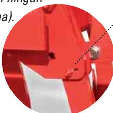
Los equipos acoplados del CULTIVADOR se encargan del guiado profundo. Mediante una máscara perforada adecuada ③ se pueden ajustar diferentes profundidades de trabajo.
