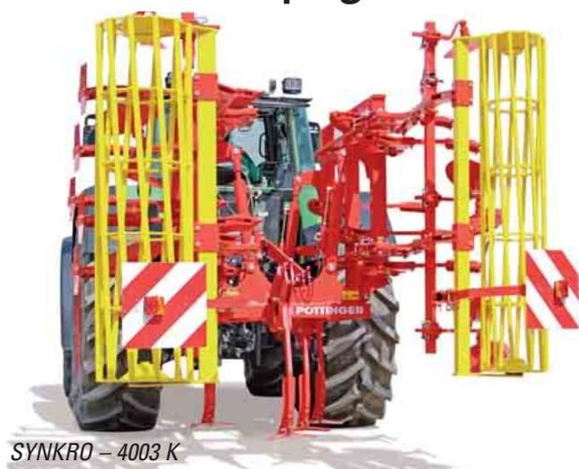
El replegamiento hidráulico del bastidor portante permite un transporte por carretera cómodo y sin problemas de menos de 3 m. El enclavamiento tiene lugar de forma automática mediante un cierre hidráulico de las posiciones extremas.
