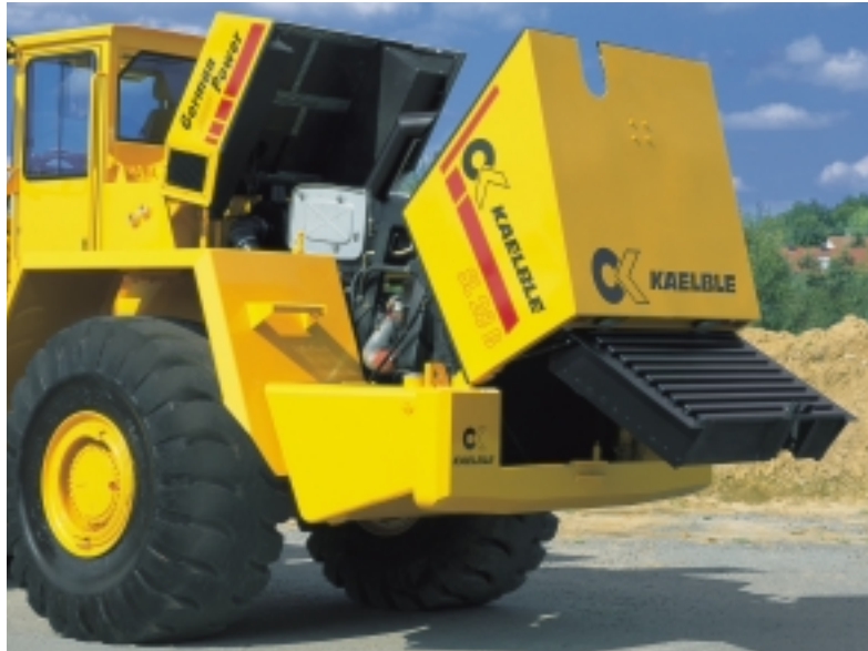
Gute Zugänglichkeit und Übersicht zum Motorraum bei allen Wartungstätigkeiten.
