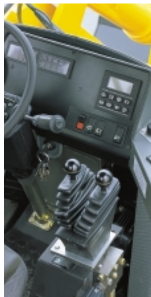
Als Sonderausrüstung mit Zentralschmieranlage ausgestattet. Wahlweise Einhebel- oder Zweihebelsteuerung in der geräuschgedämpften komfortablen Fahrerkabine.
