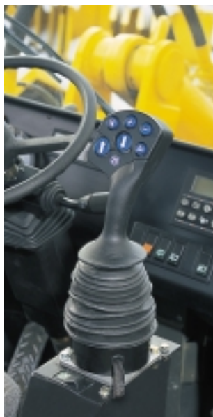
Als Sonderausrüstung mit Zentralschmieranlage ausgestattet. Wahlweise Einhebel- oder Zweihebelsteuerung in der geräuschgedämpften komfortablen Fahrerkabine.
