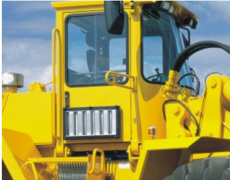
Hydroachsenlagerung und Frischluftfilterung für die Kabine.
