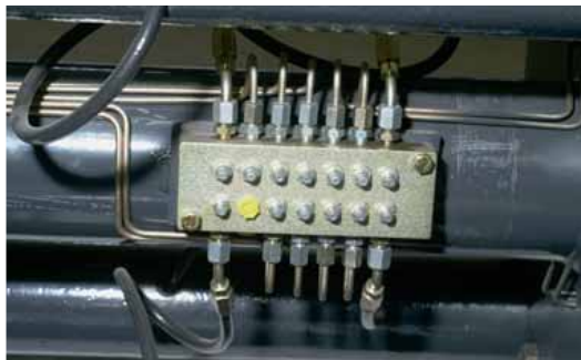
Service leicht gemacht: Alle Schmierstellen wurden auf einer Leiste zusammengefasst.
