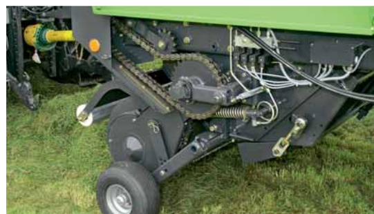
Robuster Antrieb und serienmäßige Tasträder garantieren sichere und schonende Aufnahme.
