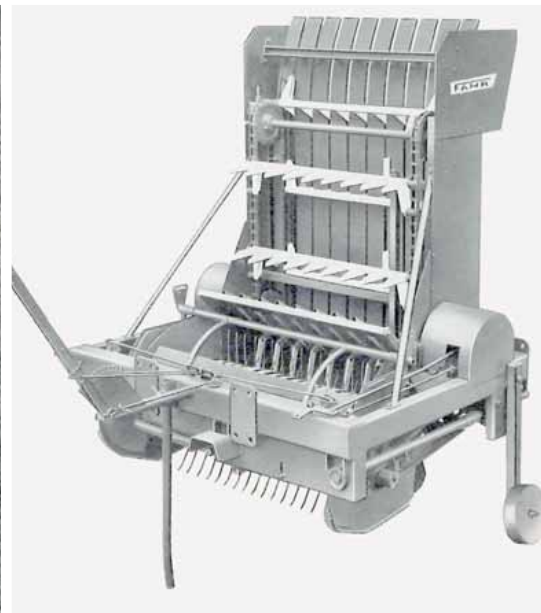
Das Förderaggregat des ersten Ladewagen. Diese Technik verkürzte die Futterernte auf ein Zehntel ihrer ursprünglichen Zeit.
