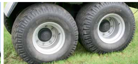
Komfortable Fahrwerke mit breiten Niederquerschnittsreifen schonen die Grasnarbe.
