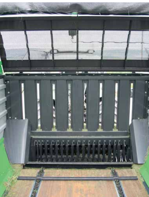
Glatte Innenwände garantieren den sicheren Vorschub des Erntegutes.
