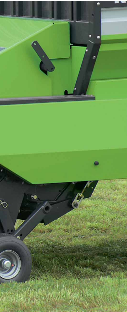
Service leicht gemacht: Alle Schmierstellen wurden auf einer Leiste zusammengefasst.
