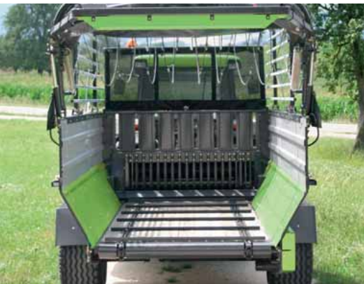
Glatte Innenwände, kraftvoller Kratzboden. Auch die kleinen Typen von DEUTZ-FAHR sind wahre Lademeister.
