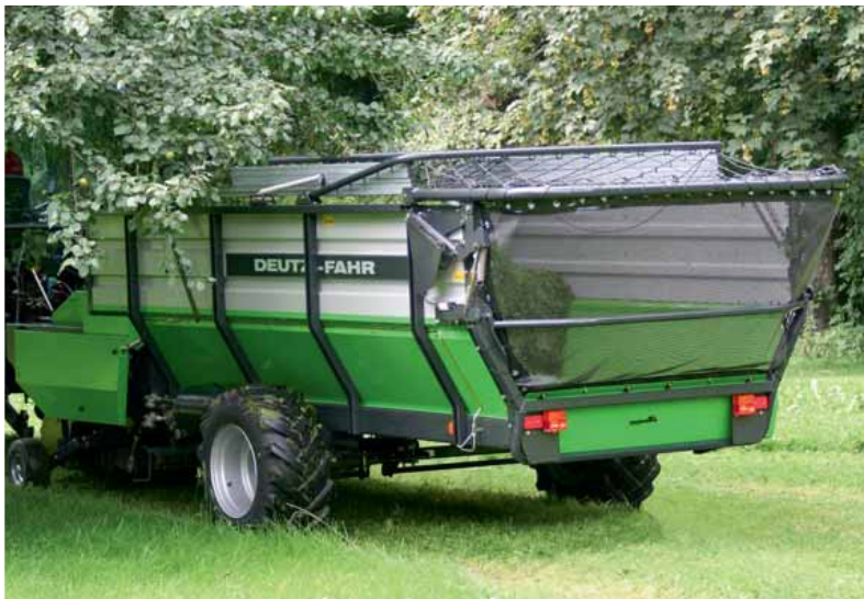
Hydraulisch verstellbarer Dürrgut Aufbau für die Modelle TL 22 - K 7.36 TA. Bequemes Anpassen der Ladehöhe aus der Traktorkabine.
