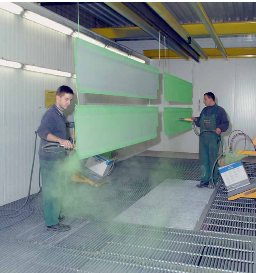
Die hochwertige Pulverlackierung schützt alle Bauteile nachhaltig vor Korrosion und Beschädigung.
