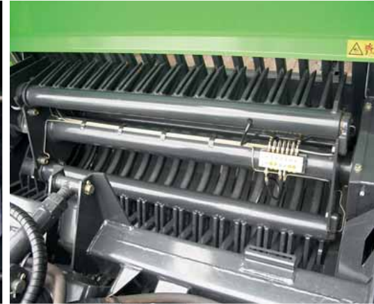
Das leistungsfähige lenkergesteuerte Förderaggregat mit geschmiedeten Doppelfingerzinken.
