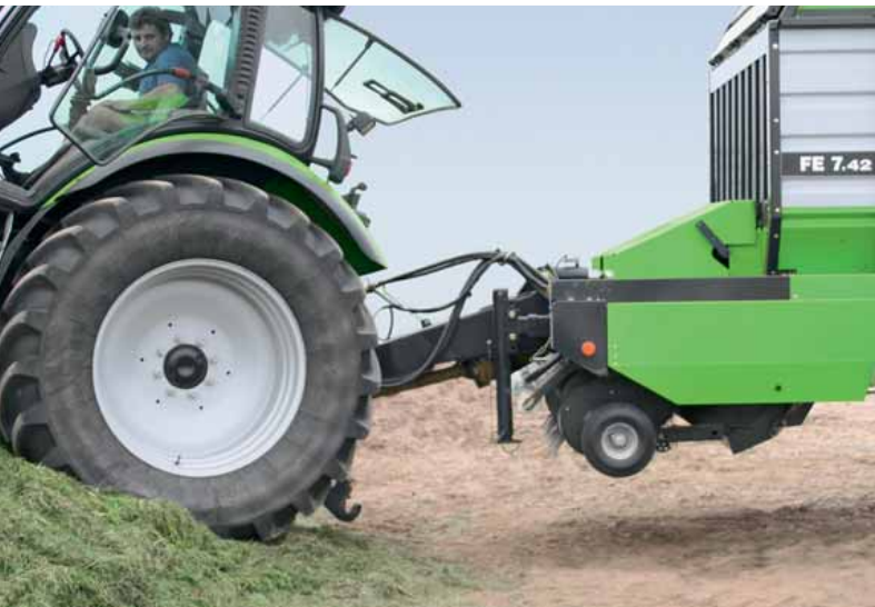
Hydraulische Knickdeichsel für die Modelle TL 22 - K 7.36. Die hohe Bodenfreiheit von bis zu 600 mm sorgt für sicheres Befahren von Rampen und Fahrsilos.
