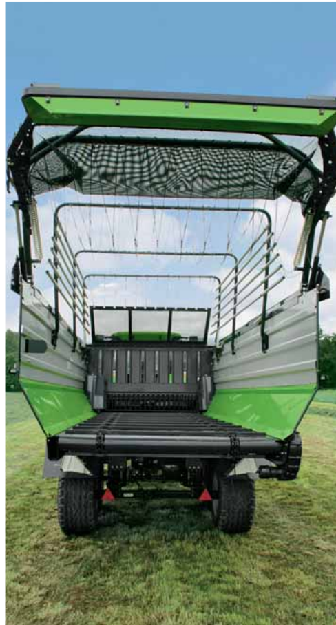
Glatte Innenwände und ein klappbarer Dürrgutaufbau.
