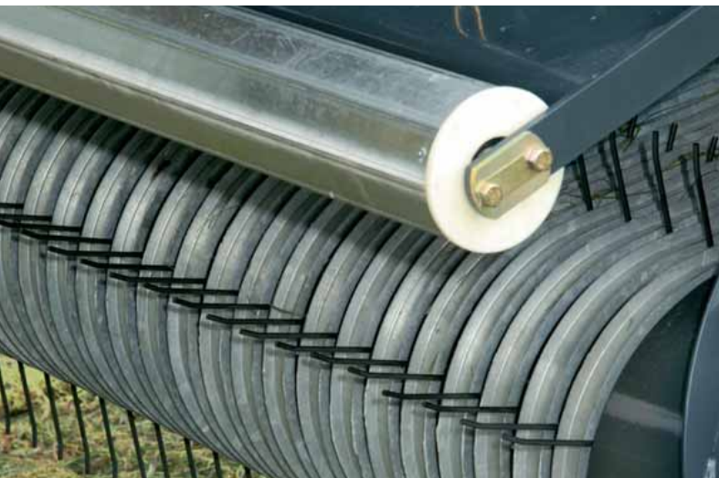
Pickup mit 1,85 m Breite. Nimmt großvolumige, breite Schwaden sicher auf. Der Rollenniederhalter ist serienmäßig (a. V. bei TL 22/TL 28).
