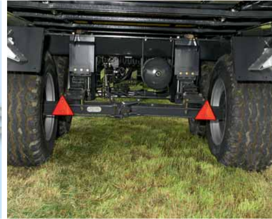
Serienmäßig gefedert und breit bereift: die Tandemachsaggregate.
