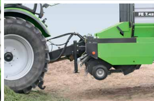
Die hydraulische Knickdeichsel ermöglicht eine Bodenfreiheit von 600 mm und somit eine sichere Anfahrt auf jedes Fahrsilo.
