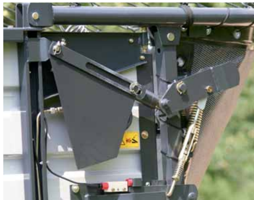
Die Rückwand wird serienmäßig hydraulisch betätigt.
