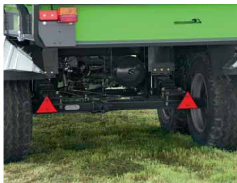
Die stabile gefederte Tandemachse sorgt für hohen Fahrkomfort (K 7.36 TA).
