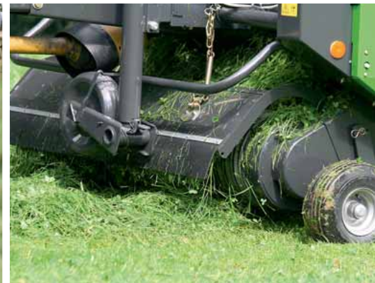
Das serienmäßige Prallblech sorgt für einen gleichmäßigen Futterteppich.
