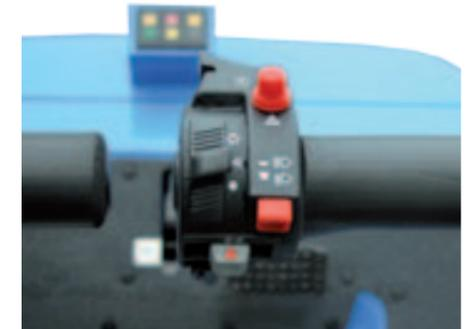
Die Steuerung der Beleuchtungsanlage erfolgt durch einen ergonomischen Spezialschalter am Lenkhebel.
