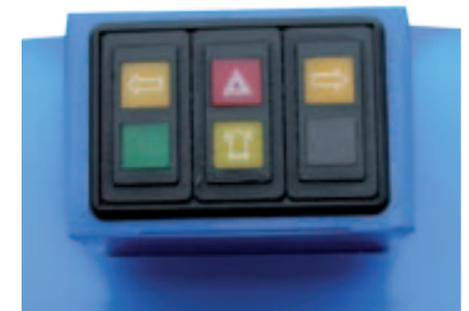
Im Blickfeld des Fahrers sind die Kontrollleuchten der Beleuchtungsanlage angebracht.
