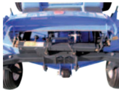
Mit dem serienmäßigen Kurbelstück kann das Gerät zur Reinigung oder Messerpflege aufgebockt werden.
