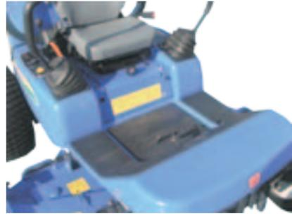
Die großzügig gestaltete Bodenwanne bietet viel Fußraum. Eine serienmäßige Gummiauflage reduziert Vibrationen und sorgt für sicheren Halt.
