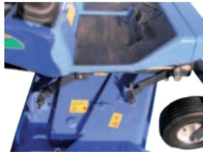
Sehr sicher ist die Aushubmechanik unter dem Trittlech angebracht. Das Mähwerk wird parallel ausgehoben und kann werkzeuglos in Sekunden demontiert werden.
