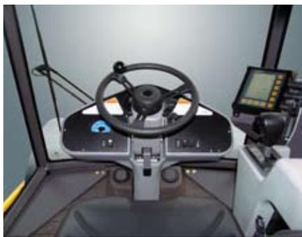
Les plus petits modèles SD25 et SD45 sont équipés de plates-formes de conduite bien isolées, avec une excellente visibilité, particulièrement utile sur les chantiers de petites envergures. Toutes les machines comprises entre le SD70 et le SD200 peuvent être équipées d'une cabine sûre et confortable, avec régulation de la climatisation pour permettre au conducteur de demeurer au mieux de sa forme d'un bout à l'autre de la journée de travail.
