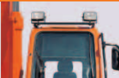
Zusatz-Arbeitsbeleuchtung an der Kabine
