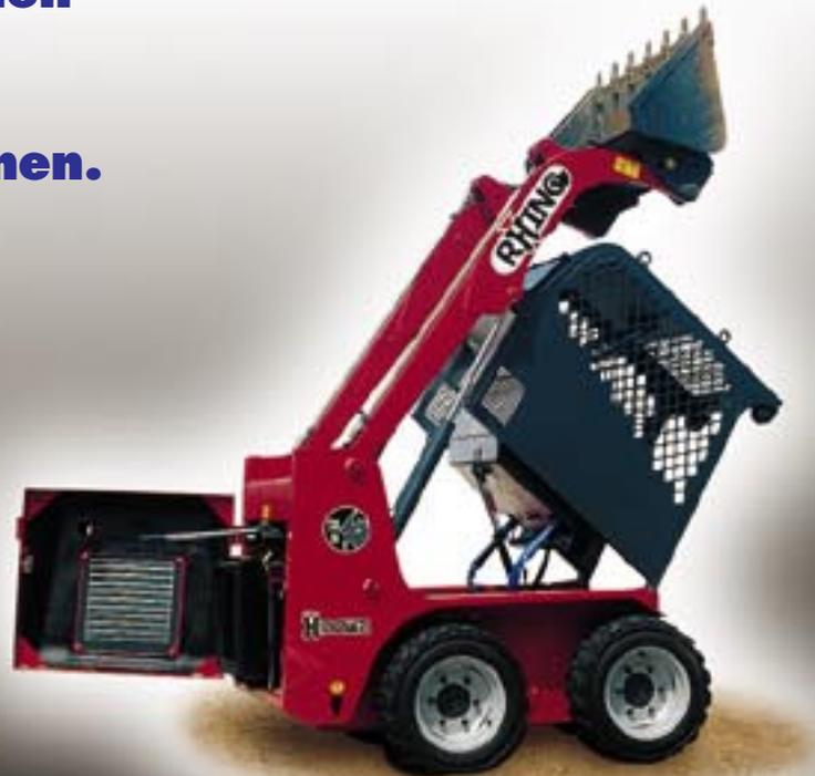
**Der hydrostatische Antrieb und die hydraulische Anlage sind einfach erreichbar und durch die hydraulische Umklippung der Kabine vollständig kontrollierbar.**
