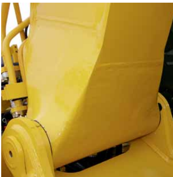
Base del braccio in fusione d'acciaio
