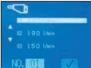
Einstellung Hydraulikölstrom in der Hammer-Betriebsart (B)
