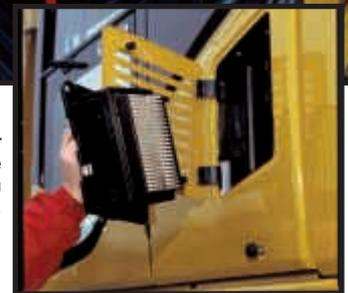
Einfaches Reinigen des Filters der Klimaanlage. Der Filter der Klimaanlage kann ohne Werkzeug zum Reinigen entnommen werden.
